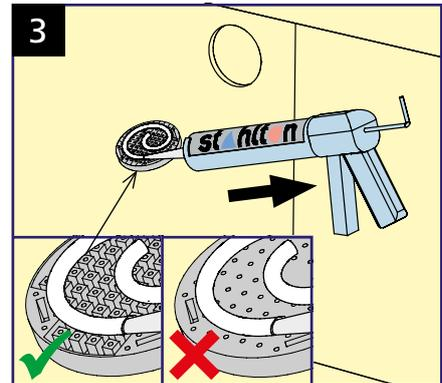
Stahlton-Montagekleber vollflächig auf Rückseite der Montagerondelle auftragen. 1 Kartusche Montagekleber (290 ml) für ca. 25 Montagerondellen
