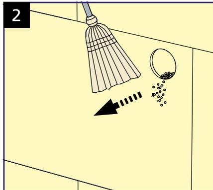
Ausfräsung von Frässtaub reinigen.
