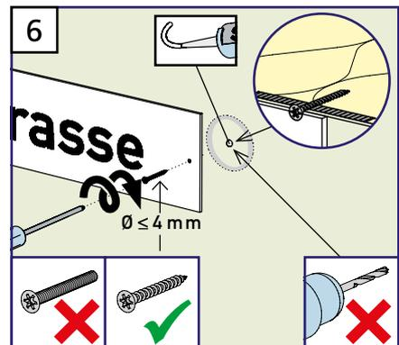
Fremdmontagen können mit Spanplatten- oder Blechschrauben ohne Schaft  $\varnothing < 4\text{mm}$  direkt in die Montagerondelle erfolgen (Verankerungstiefe  $> 20\text{mm}$ ). Putzdurchdringung dichten (z. B. Stahlton-Klebdichtstoff).
