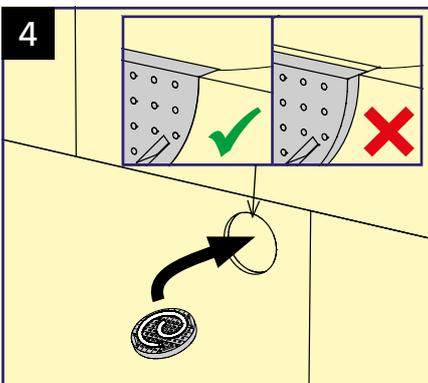
Montagerondelle dämmplattenbündig anpressen.
