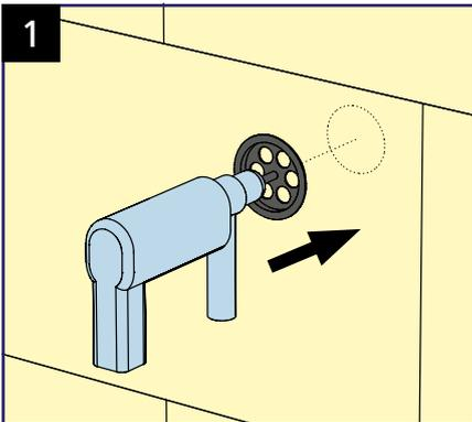
Aussparung in Dämmung fräsen.
