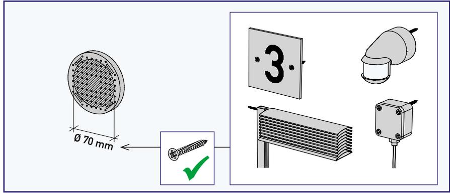
Die nutzbare Befestigungsfläche beträgt  $\varnothing 70\text{mm}$ .
