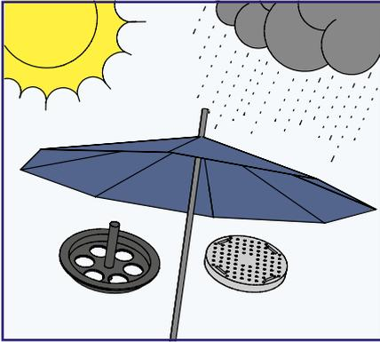
Montagerondellen und Fräswerkzeug vor Witterungseinflüssen/Verschmutzung schützen.
