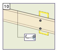
Nach Fertigstellung des Deckputzes den Übergang Verputz/Anbauteil dichten (z. B. Stahlton-Klebdichtstoff).
