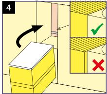
Druckquader auf tragenden Untergrund verkleben (Haftzugfestigkeit ≥ 0.25 N/mm²) und dämmplattenbündig anpressen.
