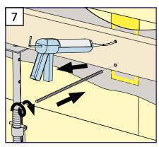
Injektionsmörtel injizieren und Gewindestangen mit drehender Bewegung einführen
