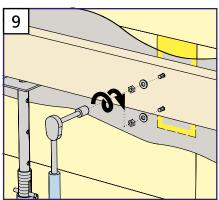
Muttern/U-Scheiben anbringen und mit dem zulässigen Montagedrehmoment gemäß Dübelhersteller anziehen.
