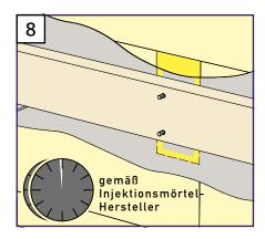
Vor dem Montieren der Muttern/U-Scheiben und aufbringen des Montagedrehmomentes die Abbindezeit gemäß Injektionsmörtel-Hersteller einhalten.
