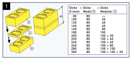
Die einzelnen Module zusammenfügen. Elementdicke D (Dämmstärke) aus den Modulen (D) und (E) gemäß Tabelle konfektionieren\* (nur nötig wenn der Druckquader nicht konfektioniert geliefert wurde). \*empfohlene Kombination (Reihenfolge Module (E) frei)
