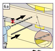
Lochsteinmauerwerk\*: Anbauteil auf Spachtelmasse positionieren. Loch bis in tragendes Mauerwerk bohren (ohne Schlag) und Siebhülse einführen.
