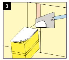
Klebemörtel (z. B. Kleber des Außendämmsystems) vollflächig auf Rückseite des Druckquaders auftragen.
